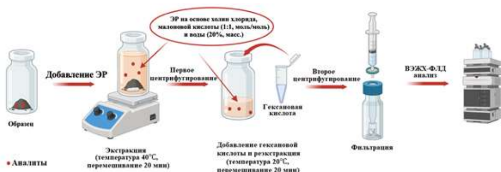
Рис. Схема определения фторхинолонов в почвах и донных отложениях.
